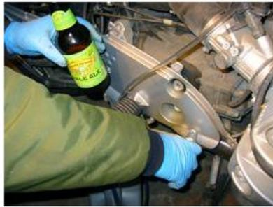
7) Quand chaque circuit de commande est terminée, retirez le tuyau de la vis de purge et nettoyer tout le liquide de frein qui peuvent avoir déversé. Lorsque tous les circuits de contrôle ont été complétées, remettre les capuchons de protection en caoutchouc. (Commande: # 1, # 2, # 3 et # 1, 2e temps).
