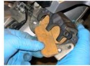
➤ **11) Ne pas actionner le levier du frein alors que les calles de bois ne sont pas installées : risque de dommages des pistons et de l'étrier de frein.**
