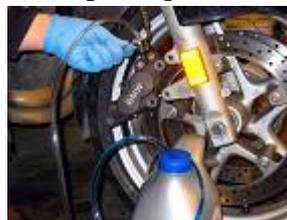
25) Remplissez l'entonnoir avec du liquide de frein DOT 4 neuf jusqu'à ce qu'il soit environ à moitié plein. Remplir lentement pour éviter de créer des bulles d'air.
