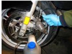
Note: Si vous utilisez des purgeurs anti retour, le clapet se ferme automatiquement empêchant l'air d'entrer dans le système.
