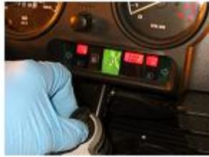
37) Appuyer lentement sur le levier de frein pour remettre en place les plaquettes contre les disques.
