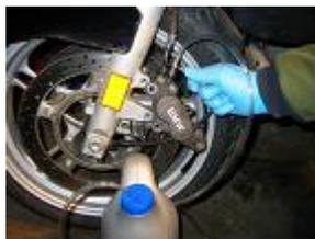
24) Brancher le tuyau de la vis de purge de l'étrier avant droit sur le bidon de surplus en plastique.
