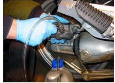
20) Régler niveau de liquide de frein en utilisant la poire à jus **propre** jusqu'à ce que l'un des trois doigts effleure la surface du liquide. (Vous devrez peut-être d'attirer et remplir pour obtenir le bon niveau.)
